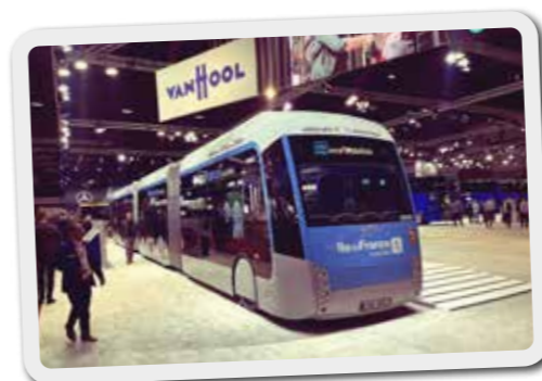
Van Hools Tzen4, som snart vil køre på nogle af de travleste ruter i Paris. Bussen er 24 meter lang, og den oplades lynhurtigt med 800 kW ladeteknologi. Bussen kan transportere ca. 140 passagerer.
